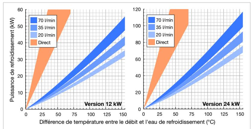
Version 12 kW, Puissance indiquée min. à 12 l/min @ 2 bar ; max. à 25 l/min @ 8 bar Eau de refroidissement.
