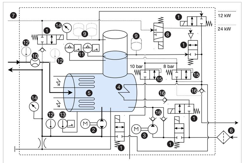
1 Vanne à 2-2 voies (normalement fermée), 2 Pompe de circulation réversible, 3 Pompe de surpression, 4 Echangeur de chaleur, 5 Résistances, 6 Filtre, 7 Alimentation en air comprimé, 8 Vanne pneumatique 2-2 voies, 9 Vase d'expansion, 10 Capteur de débit, 11 Capteurs de niveau, 12 Capteur de température, 13 Thermostat de sécurité, 14 Capteur de pression, 15 Soupape de surpression, 16 Clapet anti-retour
