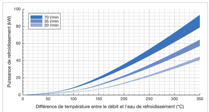
Données de performance min. à 30 l/min @ 1,5 bar ; max. à 72 l/min @ 8 bar eau de refroidissement
