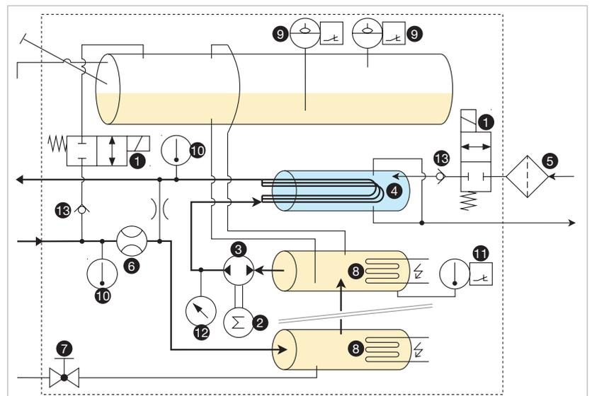
1 Vanne à 2-2 voies (normalement fermée), 2 Moteur de pompe, 3 Pompe de circulation réversible, 4 Échangeur de chaleur tubulaire, 5 Filtre, 6 Capteur de débit, 7 Vanne à boisseau sphérique, 8 Résistances, 9 Capteur de niveau, 10 Capteur de température, 11 Thermostat de sécurité, 12 Capteur de pression, 13 Clapet anti-retour
