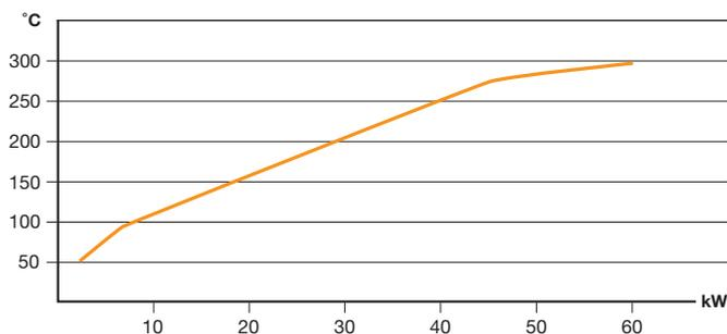
— = Capacité de refroidissement à une température d'eau de refroidissement de 12°C
