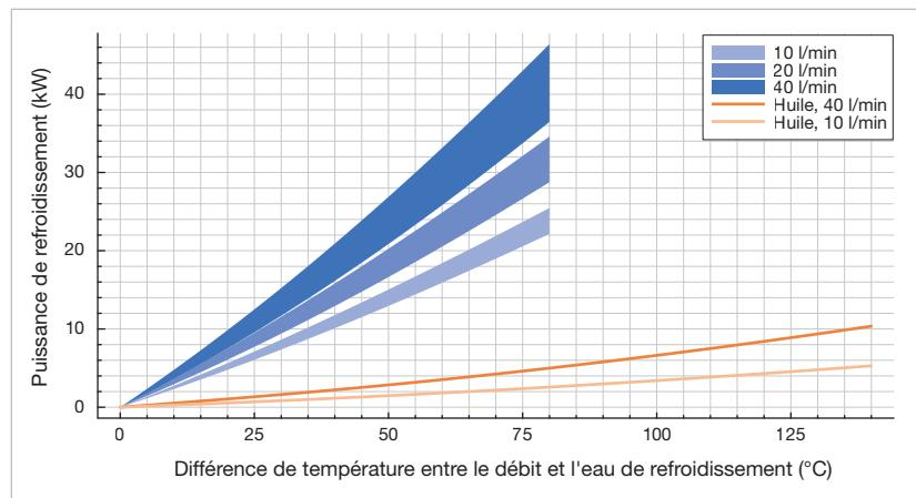
Puissance indiquée min. à 16 l/min @ 1,5 bar ; max. à 38 l/min @ 8 bar Eau de refroidissement
