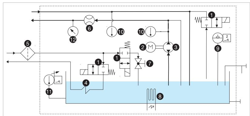
1 Vanne à 2-2 voies (normalement fermée), 2 Moteur de pompe, 3 Pompe à sens de rotation réversible, 4 Echangeur de chaleur, 5 Filtre, 6 Capteur de débit, 7 Vanne à bocal sphérique, 8 Résistances, 9 Capteur de niveau, 10 Sonde de température, 11 Thermostat de sécurité, 12 Capteur de pression
